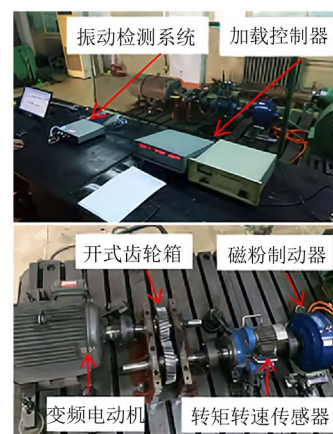
图5 振动检测试验台 [42]
